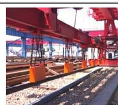
快速電磁吸鐵控制器
